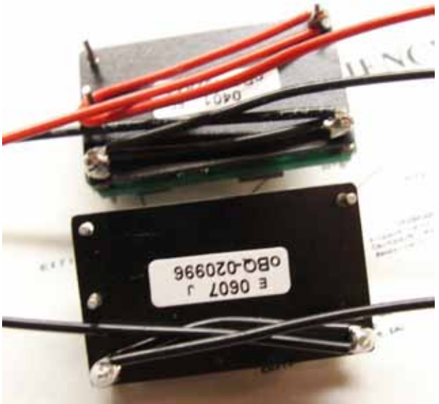
ETA 24V DC-DC unit (see spec sheet for more details)
