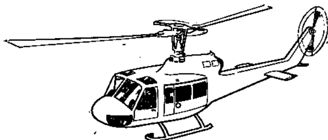
Рис. 1.2. Вертолет одновинтовой схемы с двухлопастным несущим винтом.
