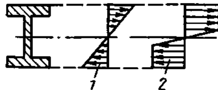
Рис. 3.36. Влияние удаления элементов от нейтральной оси на нормальные напряжения: 1 — в пределах упругости; 2 — за пределами упругости в области пластических деформаций
