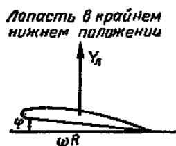
Рис. 20. Угол атаки сечения при взмахе лопасти вверх
