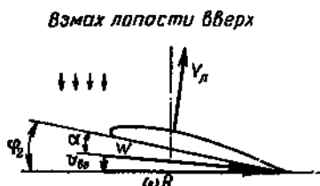
Рис. 20. Угол атаки сечения при взмахе лопасти вверх
