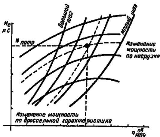
Рис. 128. График зависимости числа оборотов двигателя от шага несущего винта
