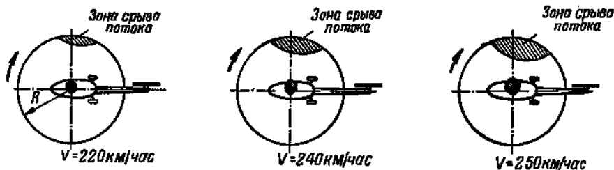
Рис. 120. Зоны срыва потока по поверхности вращения несущего винта при увеличении скорости полета
