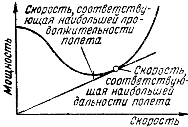
Фиг. VIII. 5. Точки на кривой потребной мощности, соответствующие скорости полета, при которых достигаются наибольшая продолжительность и дальность полета.
