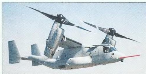
Готовясь к посадке, «Оспри» начинает переход с самолетного режима на вертолетный за счет поворота винтов
