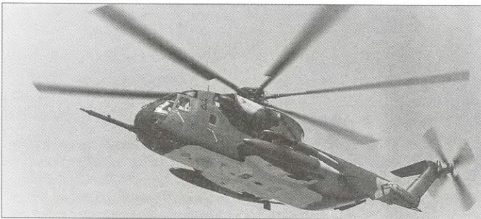
Поисково-спасательный НН-53С был дальнейшим развитием вертолета НН-53В. Запас топлива во внутренних и подвесных баках на этом вертолете уменьшен, но зато была установлена телескопическая штанга системы заправки топливом в полете. Вертолеты НН-53С из состава 55-й эскадрильи поисково-спасательных вертолетов обеспечивали подъем из воды всех спускаемых аппаратов лунной программы «Аполлон»
