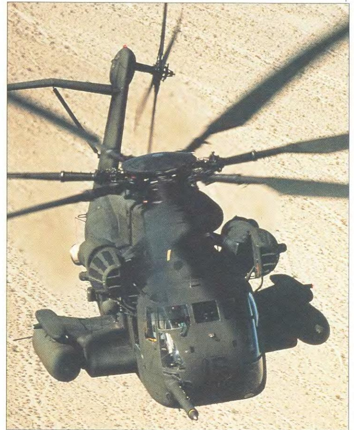
Вертолет СН-53Е «Супер Стэллион» может заправляться топливом в полете от самолета-заправщика Локхид КС-130. Вертолеты, созданные в Советском Союзе, превосходили СН-53Е по мощности силовой установки и грузоподъемности, тем не менее за рубежом называют вертолеты семейства Н-53 «самыми настоящими тяжелыми грузовыми вертолетами»
