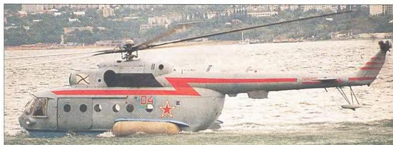
Вертолет Ми-14 может приводниться при волнении 3-4 балла или глиссировать со скоростью 60 км/ч. На фото видны надувные баллоны и хвостовая опора, сделанная в виде небольшого поплавка
