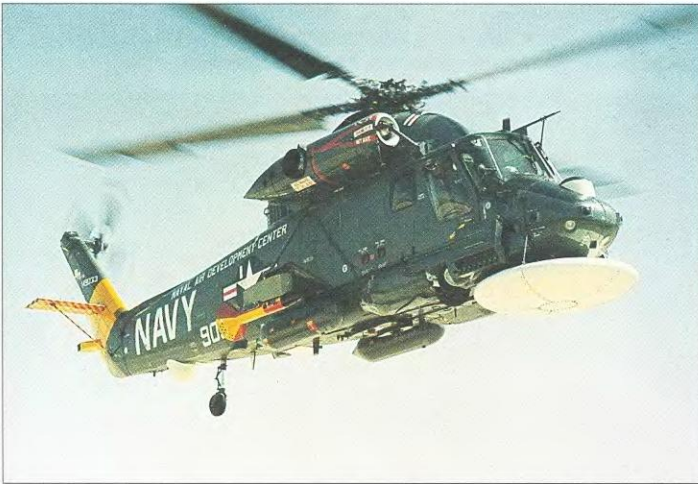
Показанный на фото опытный вертолет YSH-3E (первоначально был построен как многоцелевой UH-2A, а затем переоборудованный в поисково-спасательный HH-3D) использовался в научно-исследовательском центре морской авиации (NADC) в качестве летающей лаборатории для испытаний РЛС и других систем, предназначенных для вертолетов, разрабатываемых по программам LAMPS II и LAMPS III
