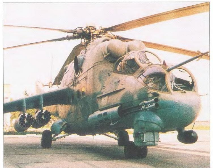
На последних модификациях вертолета Ми-24 могут устанавливаться ракеты класса воздух – воздух типа «Игла», хотя их применение пока не вышло из стадии эксперимента. На внутреннем пилоне виден контейнер Б-8В-20. Каждый такой контейнер содержит 20 РС С-8 калибром 80 мм, предназначенных для поражения целей на открытой местности или слабозащищенных
