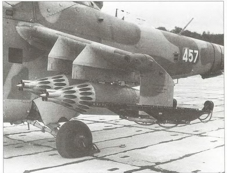
Четыре подкрыльных контейнера УВ-32-57 с РС калибром 57 мм применяются при огневой поддержке сухопутных войск. Свою высокую эффективность они доказали во время войны в Афганистане
