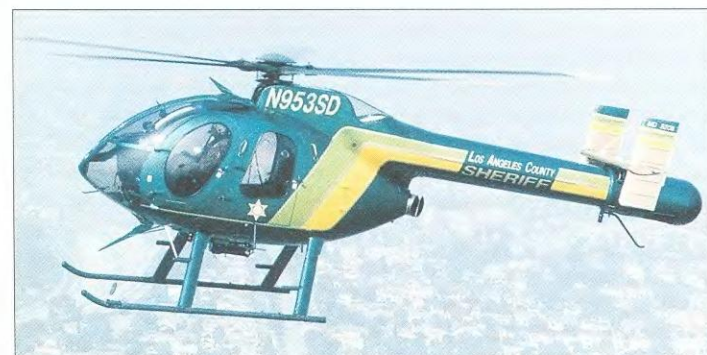
Как и многие американские полицейские подразделения, Управление шерифа графства Лос-Анджелес имеет в строю 15 вертолетов семейства MD500. На фото показан вертолет MD520N с системой NOTAR
