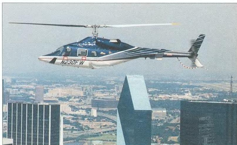
В 1983 г. фирма «Белл» представила новый вариант вертолета 222 – специализированную многоцелевую транспортную машину 222UT. Она имела увеличенный запас топлива (930 л) и полозковое шасси
