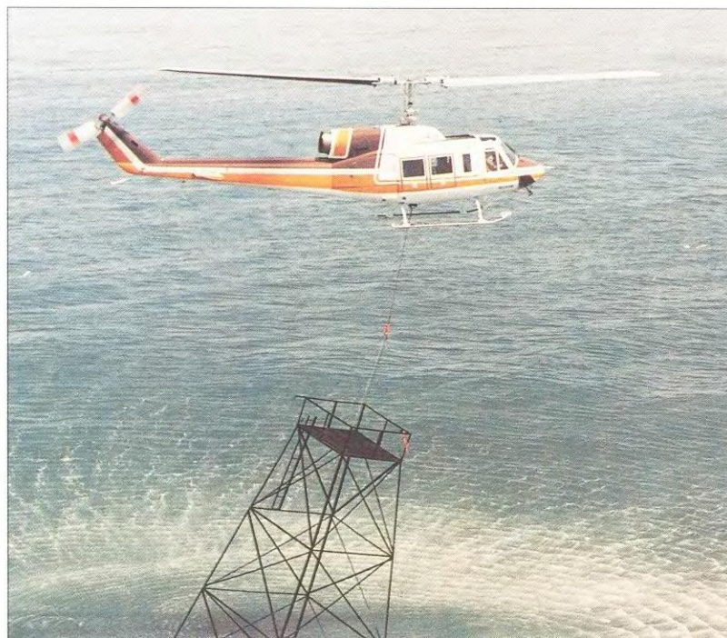
Вертолет 214В «Биг Лифтер» – чисто гражданская машина. На внешней подвеске он может перевозить грузы массой 3630 кг. При необходимости мог применяться для тушения пожаров. В кабине вертолета могли разместиться до 14 пассажиров
