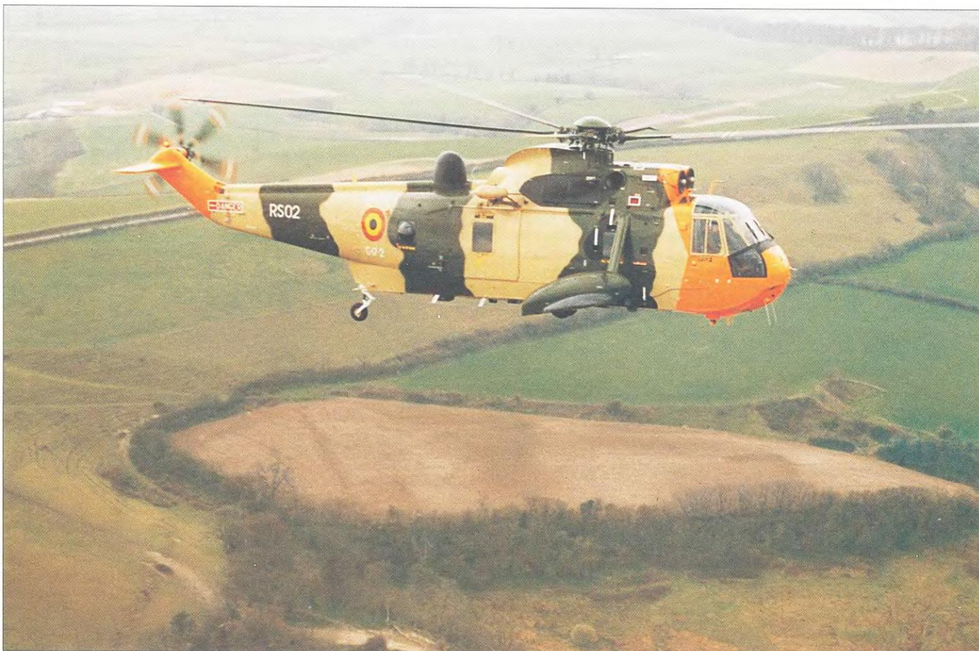
Показанный на фото вертолет «Си Кинг» Mk.48 бельгийских ВМС во многом был идентичен поисково-спасательным вертолетам HAR.Mk.3 английских ВВС, но был оснащен двигателями и шестилопастным рулевым винтом от вертолета HAS.Mk.2. В 1983 г. фирма «Уэстленд» модернизировала вертолеты, установив новое навигационное оборудование и тепловизионную систему на турельной подвеске в носовой части фюзеляжа
