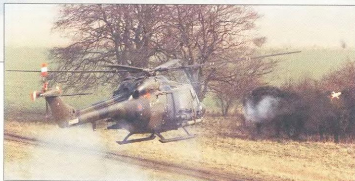
В августе 1978 г. вертолет «Линкс» AH.Mk.1 был принят на вооружение британской армии. На фото показан вертолет в момент пуска ПТУР «Тоу» с подвески на правом борту
