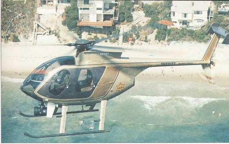
В 1982 г. фирма «Хьюз» окончательно отказалась от использования на вертолетах семейства «Модель 500» каплевидного фюзеляжа, заменив его более обтекаемым с удлиненной носовой частью. На фото показан вертолет 500E, который любят покупать правоохранительные организации
