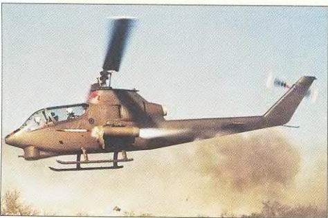
Вертолет АН-1G в момент залпа РС из контейнеров. Фото сделано во время испытаний вооружения. Видно также, что этот вертолет является одним из первых серийных, он имеет «чистый» обтекаемый нос.
