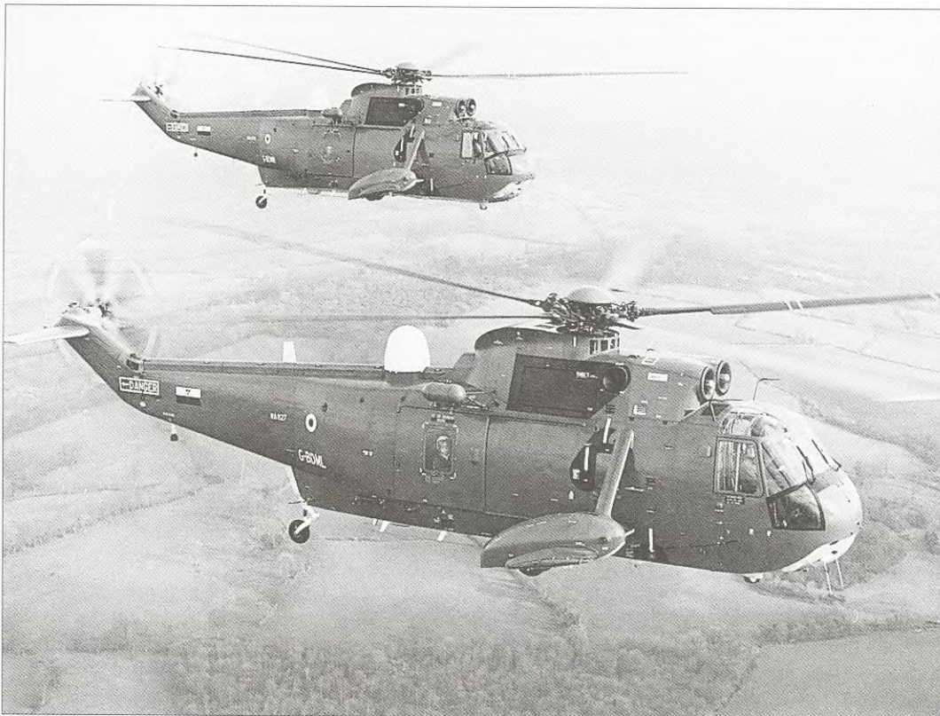
Показанный на фото вертолет «Си Кинг» Mk.48 бельгийских ВМС во многом был идентичен поисково-спасательным вертолетам HAR.Mk.3 английских ВВС, но был оснащен двигателями и шестилопастным рулевым винтом от вертолета HAS.Mk.2. В 1983 г. фирма «Уэстленд» модернизировала вертолеты, установив новое навигационное оборудование и тепловизионную систему на турельной подвеске в носовой части фюзеляжа
