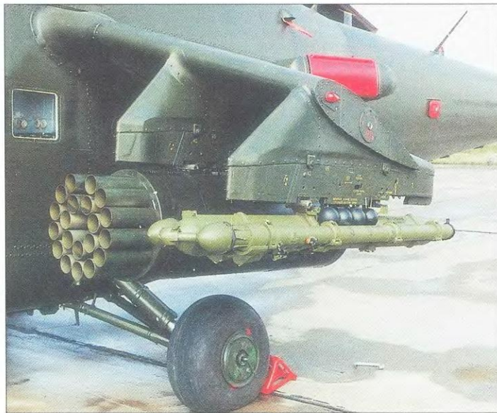
На последних модификациях вертолета Ми-24 могут устанавливаться ракеты класса воздух – воздух типа «Игла», хотя их применение пока не вышло из стадии эксперимента. На внутреннем пилоне виден контейнер Б-8В-20. Каждый такой контейнер содержит 20 РС С-8 калибром 80 мм, предназначенных для поражения целей на открытой местности или слабозащищенных
