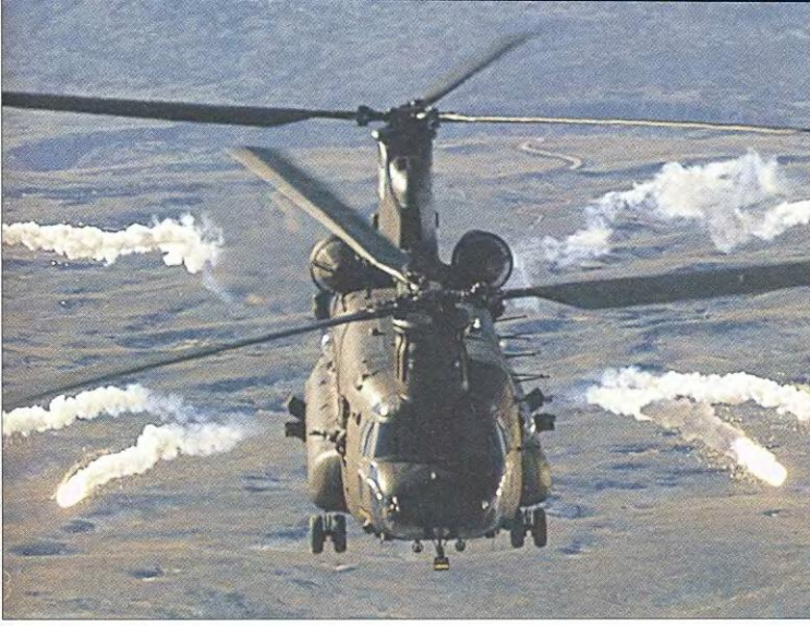
Для участия в операциях в Боснии английские вертолеты «Чинук» HC.Мк.2 были оснащены системой отстрела тепловых ловушек ALE-40 для защиты от переносных зенитных ракетных комплексов с тепловыми головками наведения. На фото показан один из вертолетов, принадлежащий 1310-й эскадрилье, в момент отстрела ловушек
