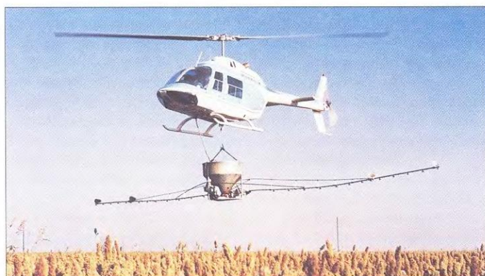
«Джет Рейнджеры» нашли широкое применение в различных отраслях экономики. Показанный на фотографии «Джет Рейнджер» I несет на внешней подвеске устройство для опрыскивания химикатами сельскохозяйственных угодий
