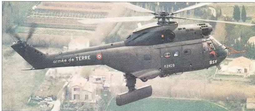
Во время войны в Персидском заливе в 1991 г. армия Франции проводила испытания вертолетов «Пума» с подфюзеляжной поисковой РЛС «Оризон». В настоящее время подобная система используется на вертолетах «Кугар»
