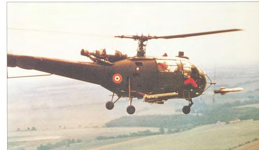
Ракета AS 12 появилась на вооружении в 1960 г. и до сих пор состоит на вооружении вертолетов «Алуэтт» III в армиях некоторых стран. Вертолет SA 316В несет четыре ракеты, используя их против танков. Ракеты AS 12 оснащаются различными боевыми частями (БЧ): бронебойными, кумулятивными и осколочными. Подрыв БЧ происходит, когда ракета преодолевает 20-мм броню. Взрыв происходит внутри цели на расстоянии 2 м от брони. Самое известное боевое использование ракет AS 12 произошло во время англо-аргентинского конфликта из-за Фолклендских островов в Южной Атлантике. Там с их помощью английские вертолеты Уэстленд «Уосп» повредили аргентинскую подводную лодку «Санта Фе». В настоящее время ракеты AS 12 заменяются на более эффективные ПТУР НОТ
