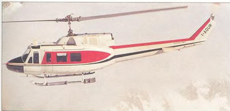
Выпускаемый в Италии фирмой «Агуста» вертолет AB 212 ничем не отличался от исходной американской «Модели 212». Итальянцы смогли разработать собственный вариант – противолодочный и противокорабельный вертолет AB 212ASW
