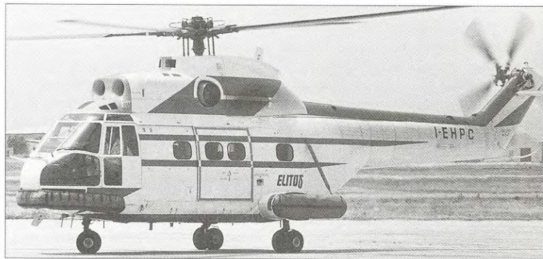
С самого начала основной областью применения вертолетов «Пума» и «Супер Пума» было материально-техническое обслуживание нефтедобывающего сектора экономики. На фотографии показан зарегистрированный в Италии вертолет SA 330J (с дополнительным надувным поплавковым шасси), принадлежащий компании «Шелл Мальта Лимитед»
