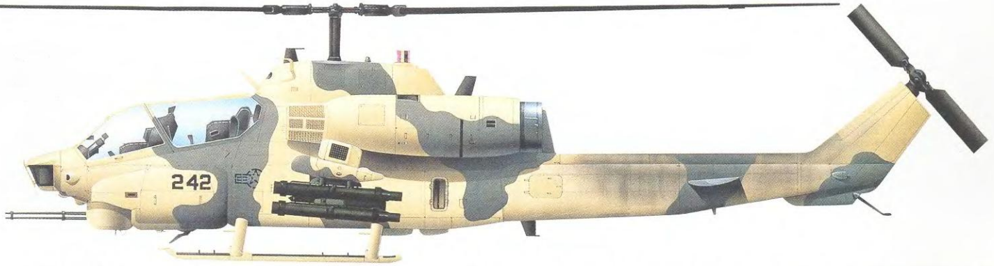
Боевой вертолет АН-1W («Виски Кобра») в качестве стандартного вооружения несет два блока по четыре ПТУР BGM-71 «Тоу» и два контейнера LAU-68 с РС
