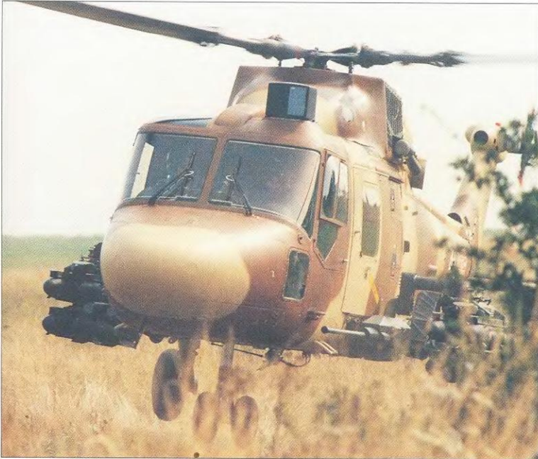
Вертолет «Линкс» 3 был построен фирмой «Уэстленд» для демонстрации его возможностей в качестве боевого. Он имел хвостовую балку от вертолета WG.30, более мощные двигатели и переделанные воздухозаборники, а также несущий винт типа BERP
