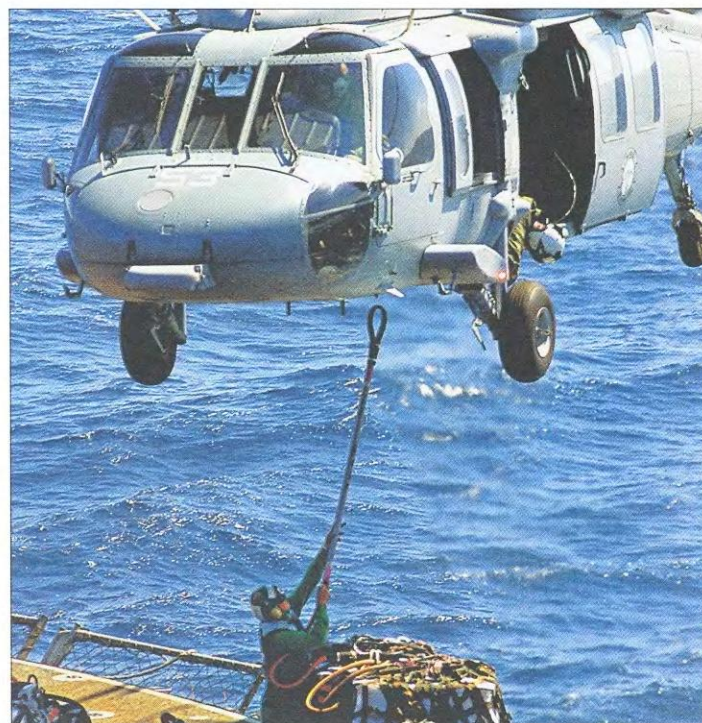
Вертолет HH-60H легко распознать по двум большим окнам на левой двери кабины. На фото вертолет показан в момент выполнения операции VERTREP
