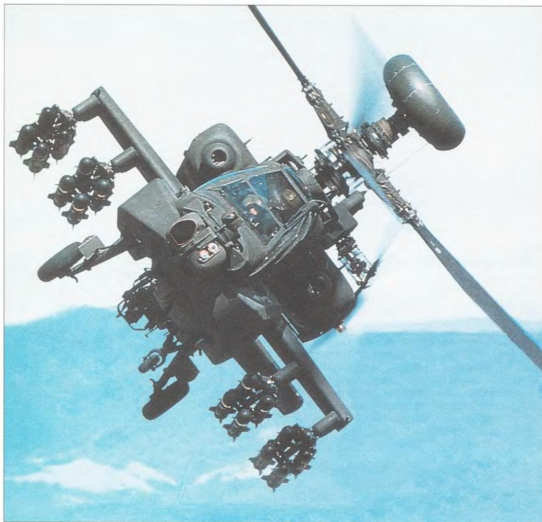
В качественном отношении вертолет AH-64D превзошел своего предшественника. С помощью нового оборудования он может отслеживать до 1024 потенциальных целей. Из них 128 могут быть идентифицированы и распределены по степени нарастания угрозы, а затем выбираются 16 наиболее опасных целей, по которым наносится удар
