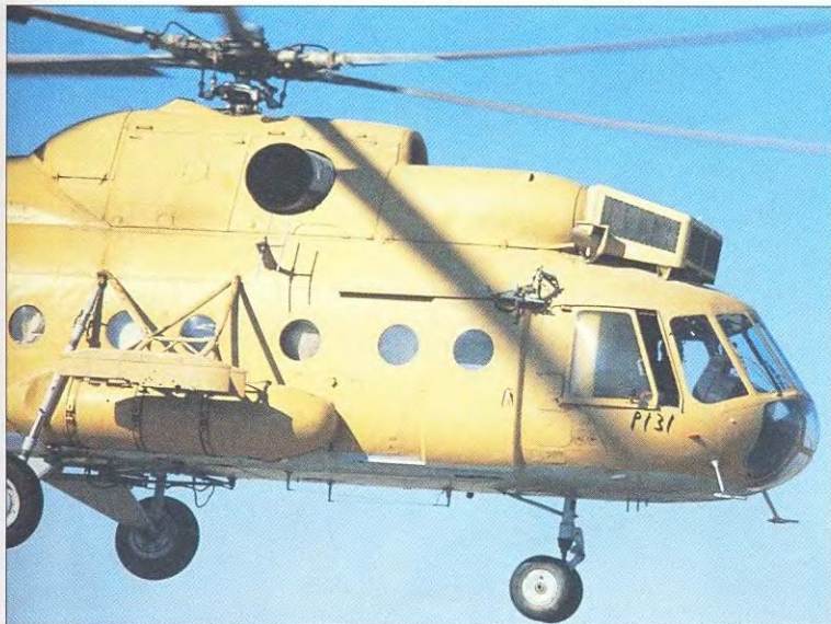
Большинство вертолетов, находящихся на вооружении ВВС Египта, имеют на воздухозаборниках двигателей противополевые фильтры, изготовленные в Великобритании фирмой АРМЕ. С их помощью удалось резко увеличить ресурс силовой установки и продлить срок службы вертолета
