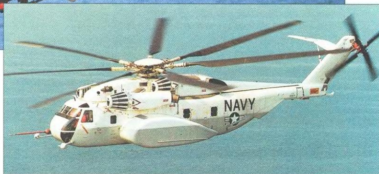
Второй предсерийный вертолет «Супер Стэллион» был изготовлен в варианте вертолета-тральщика MH-53E «Си Дрэгон». Он имел большие боковые обтекатели, служившие топливными баками, и зеркала заднего вида, установленные в передней части фюзеляжа
