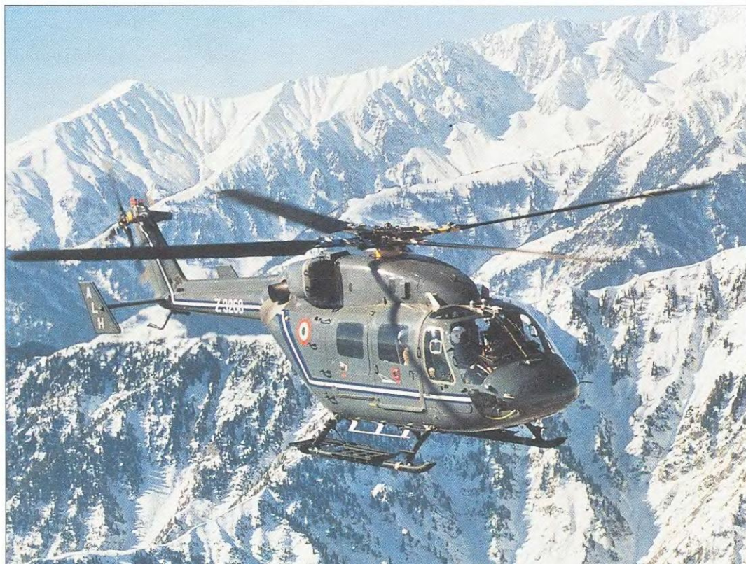
Первый вертолет ALH поступил на вооружение в марте 2002 г. Грузовая кабина вертолета имеет с каждой стороны широкие двери, сдвигающиеся по направляющим назад, а в хвостовой части двухстворчатую дверь
