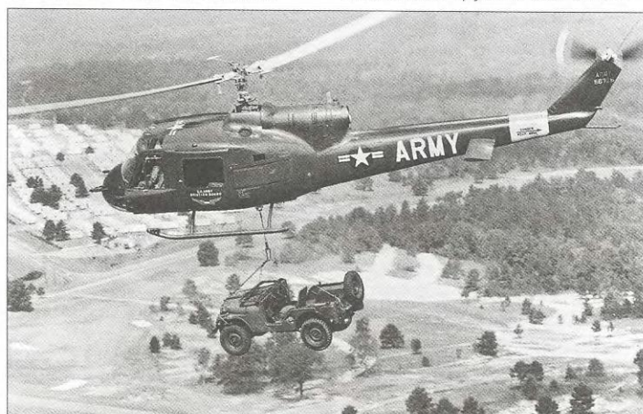
Окрашенный в оливковый цвет предсерийный вертолет УН-40 (бортовой номер 56-6726) несет на внешней подвеске джип М551. Этот вертолет был одной из шести предсерийных машин УН-40, которые в серийном производстве получили обозначение НУ-1А
