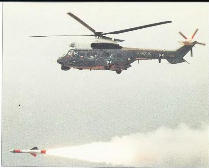
Для базирования на корабле у морского вертолета AS 332F1 хвостовая балка складывается. В состав вооружения входят противокорабельные ракеты AM39 «Экзосет»
