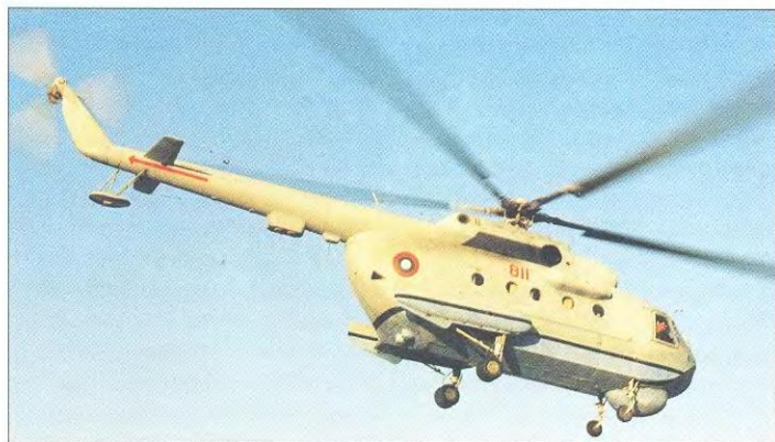
Вертолет-тральщик Ми-14БТ не имеет буксируемого магнитометра. Вместо этого в хвостовой части фюзеляжа устанавливается оборудование для буксировки трала. Было построено 25 – 30 вертолетов Ми-14БТ, из которых два были поставлены на вооружение морской авиации Болгарии (см. фото)
