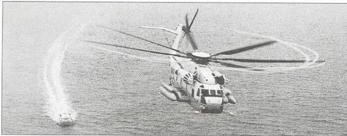
Сравнительно простая идея установить на вертолет Н-53 третий двигатель привела к появлению нового мощного вертолета СН-53Е «Супер Стэллион». На фото показан опытный вертолет-тральщик УМН-53Е, буксирующий минный трал АЛО-166 на подводных крыльях
