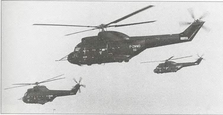
Первые три опытных вертолета SA 330 в совместном полете. На двух вертолетах видны установленные в носовой части фюзеляжа штанги с различными датчиками
