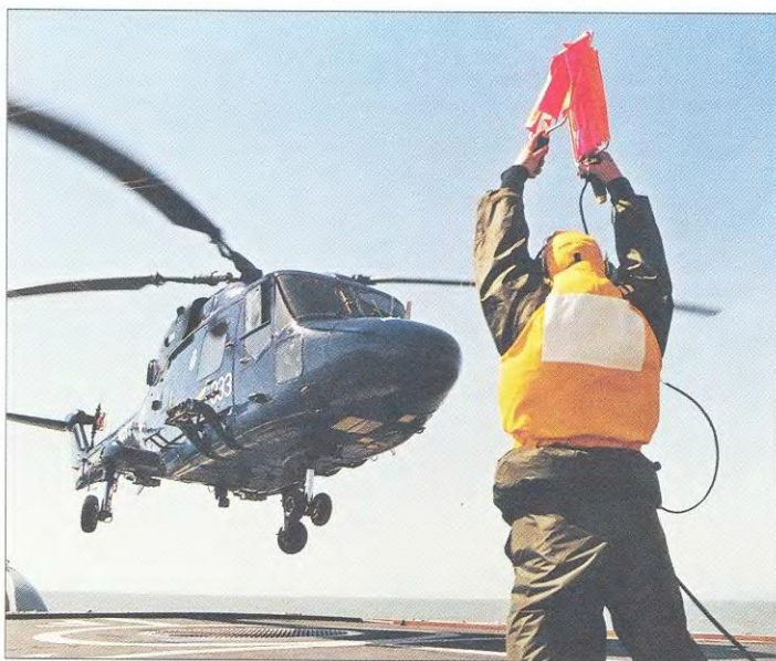
Вертолет «Линкс» имеет вполне обычную, почти полностью цельнометаллическую конструкцию. При этом в ней удачно сочетаются некоторые технические новшества. Не последнее место среди них занимает несущий винт, у которого втулка и торсионы лопастей представляют собой монолитную конструкцию из титана
