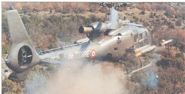
Совершая полет на уровне вершущек деревьев, вертолет SA 342 пускает ПТУР HOT. Ракета HOT, созданная совместно Францией и Германией, размещается в цилиндрическом пусковом контейнере и управляется по проводам
