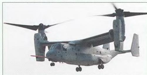
Вращаясь в горизонтальной плоскости, винты обеспечивают возможность выполнения вертикальных режимов полета, в том числе зависание при погрузочно-разгрузочных работах
