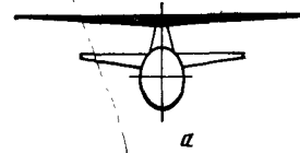
Рис. 1.7. Схема одновинтового вертолета с крылом (а), винтокрыл (б)
