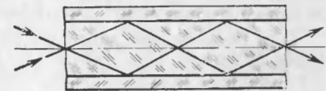
Рис. 3.2. Схема прохождения светового луча по световоду
