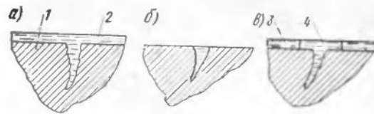
Рис. 3.5. Схема капиллярной дефектоскопии
