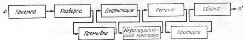
Рис. 1.6. Схема движения ремонтируемого изделия
